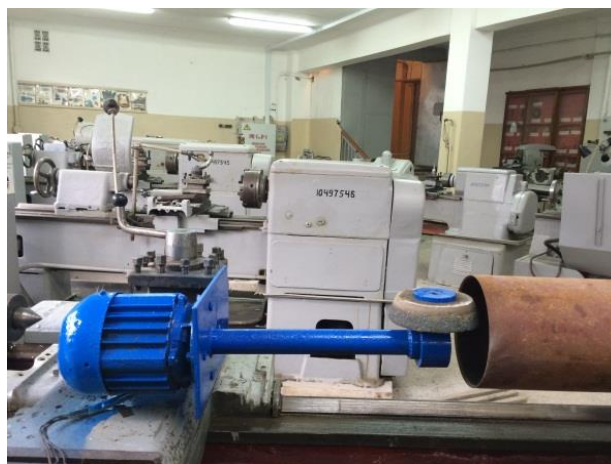
Рис. 1 – Схема обробки шліфуванням отвору у циліндрі
